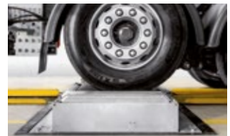
Lkw-Bremsenprüfung: Hubvorrichtung für höheren Bremsdruck
