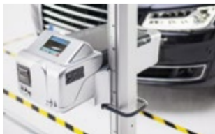
MLD 815: digitale Scheinwerferprüfung nach Richtlinie
